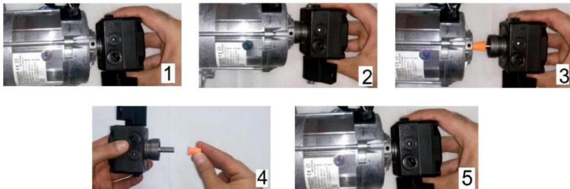
شکل ۴) جداسازی و اتصال پمپ گازوییل
