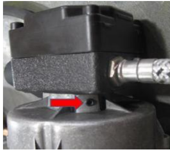
شکل ۷) پیچ اتصال پمپ به شافت موتور
