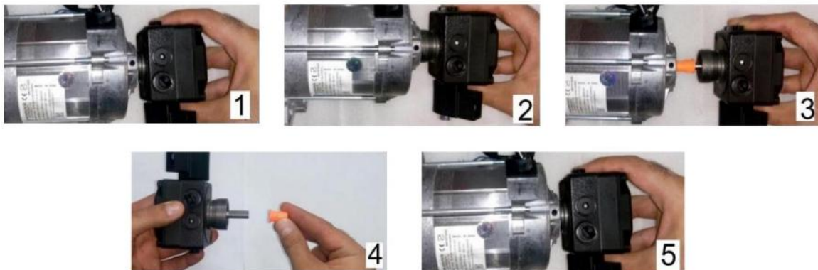
شکل ۸) جداسازی و اتصال پمپ گازوییل در هیتر دوگانه سوز
